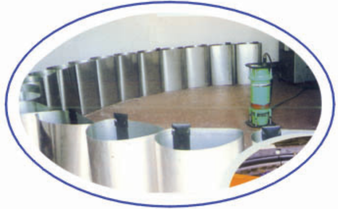
波纹管纵向焊缝100%X射线探伤
